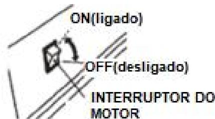
Volte a colocar a chave na posição ON quando o motor iniciar. Não use o arrancador mais de 5 segundos de cada vez. Se o motor não arranca, liberte o interruptor e aguarde 10 segundos antes de operar o arrancador novamente.
